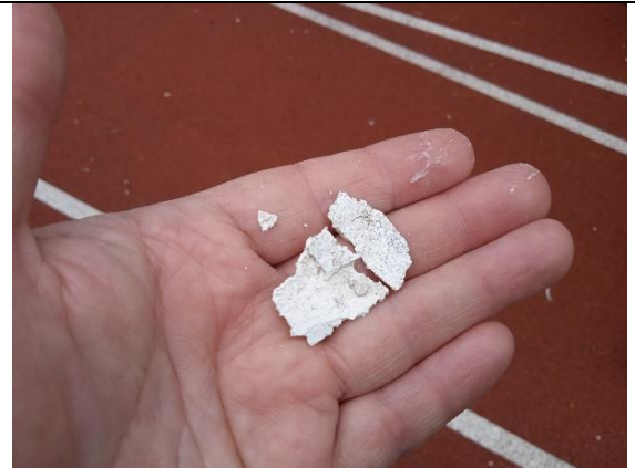
Fotografía N°: 8 Materia: Defectos en la aplicación de intumescente F-60.
