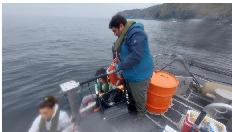
Figura 6: Muestreo 27 de abril 2023. Medición con sonda multiparamétrica y toma de muestra de agua superficial para análisis de concentración de coliformes fecales.
